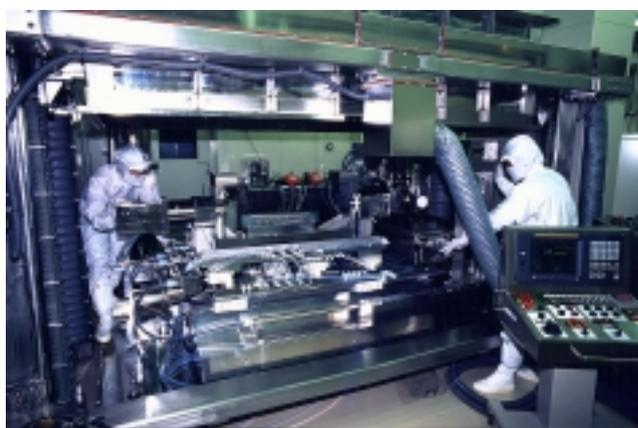
図4 数値制御 EEM 加工装置
