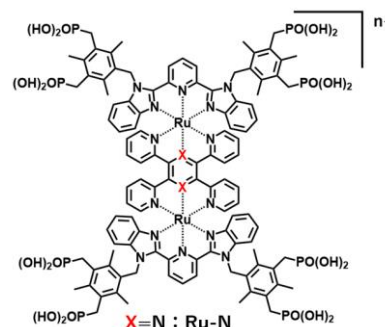
図 1 Ru-N の化学構造
